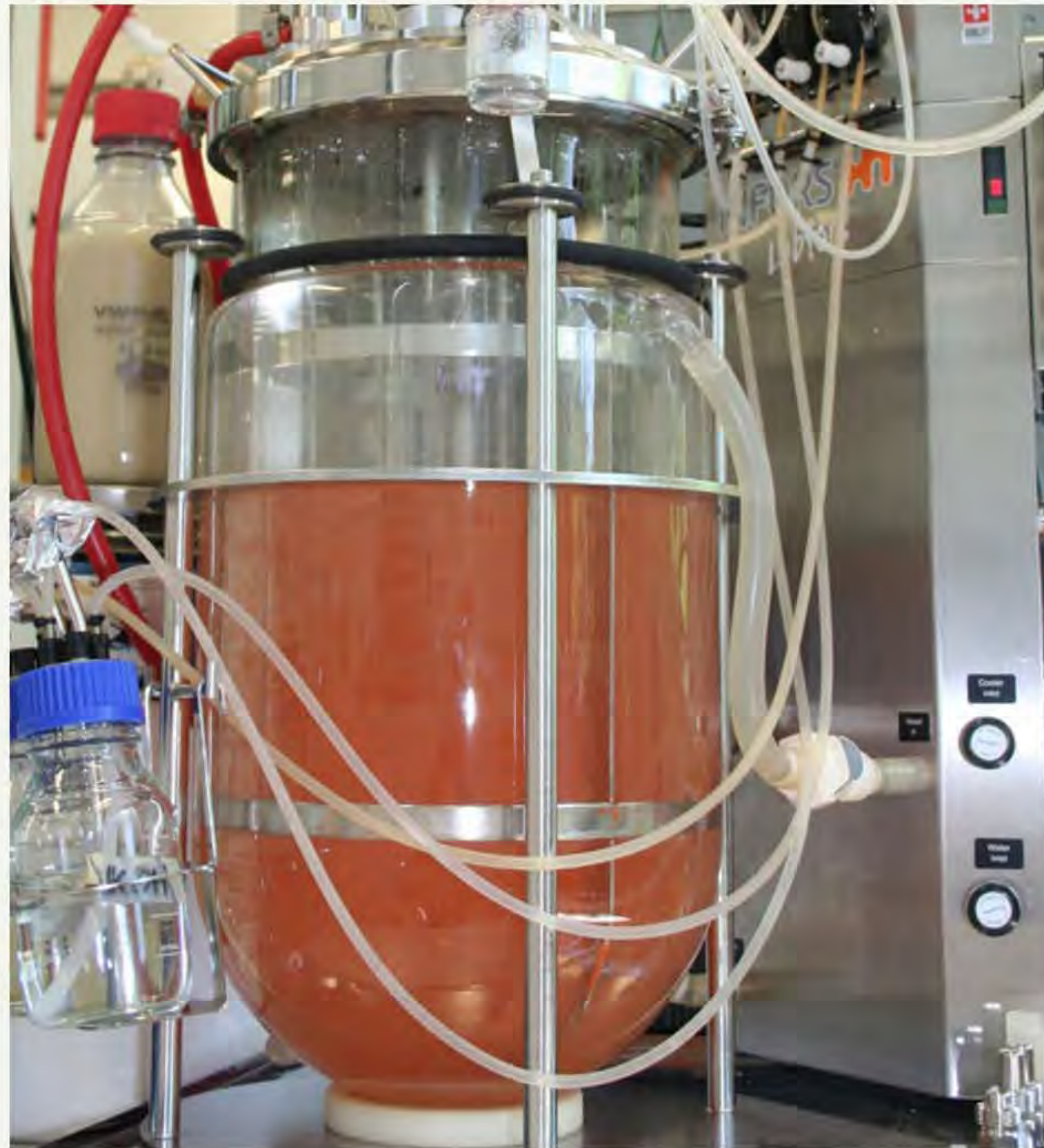
Fermentation eines Myxobakteriums im kleinen Maßstab zum Austesten geeigneter Kultivierungsbedingungen
