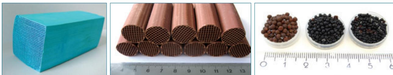
Abbildung 3: MOF-Monolithe (Wabenstruktur) (links: HKUST-1, Mitte: Fe(btc)) und MOF-Kugeln (rechts: Fe(btc)).<sup>1,2,3</sup>
