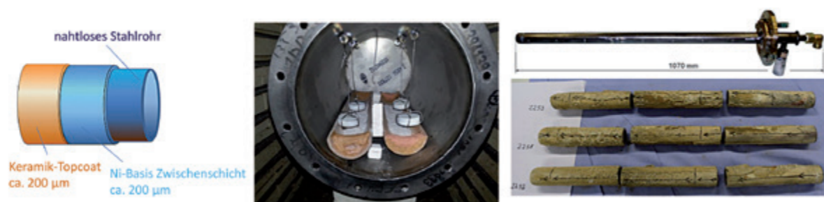
Abbildung 4.1.10.1 Schichtkombination auf Wärmetauscherrohr (links), beschichtete Massivproben im Laborversuch (Mitte) und Sondenrohre für in-line Untersuchungen vor (unbeschichtet, rechts oben) und nach dem Kraftwerkseinsatz (aschebelegt, rechts unten).
