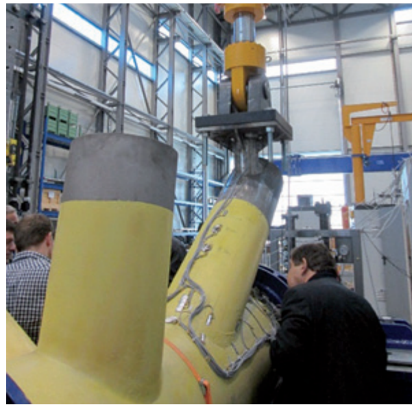
Abbildung 4.1.6.5 Demonstratorknoten im Wechsellast Prüfaufbau beim IWES
