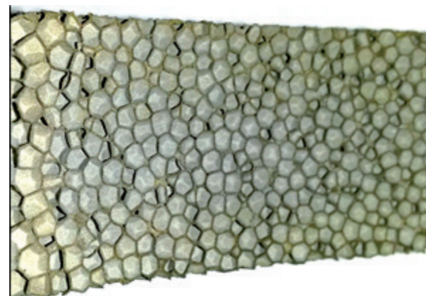
Abbildung 3.1.4.3 PZS-Bogensegment vor dem Fügen in bauteilähnlicher Geometrie
