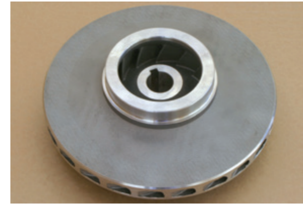
Abbildung 3.1.17.2 Mittels LBM erzeugter Pumpenlaufrad-Demonstrator aus Edelstahl nach AM-gerechter Neukonstruktion (Quelle: KSB SE & Co. KGaA)
