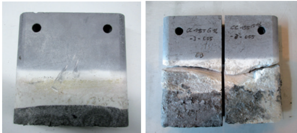
Abbildung 4.1.1.1 Links: CC 155 G16, ohne Zusatz, BN-G, gefräst und geschliffen, Einsatzdauer 48 Stunden. Rechts: CC 155 G16, Zusatz, feingefräst und poliert, Einsatzdauer 60 Stunden
