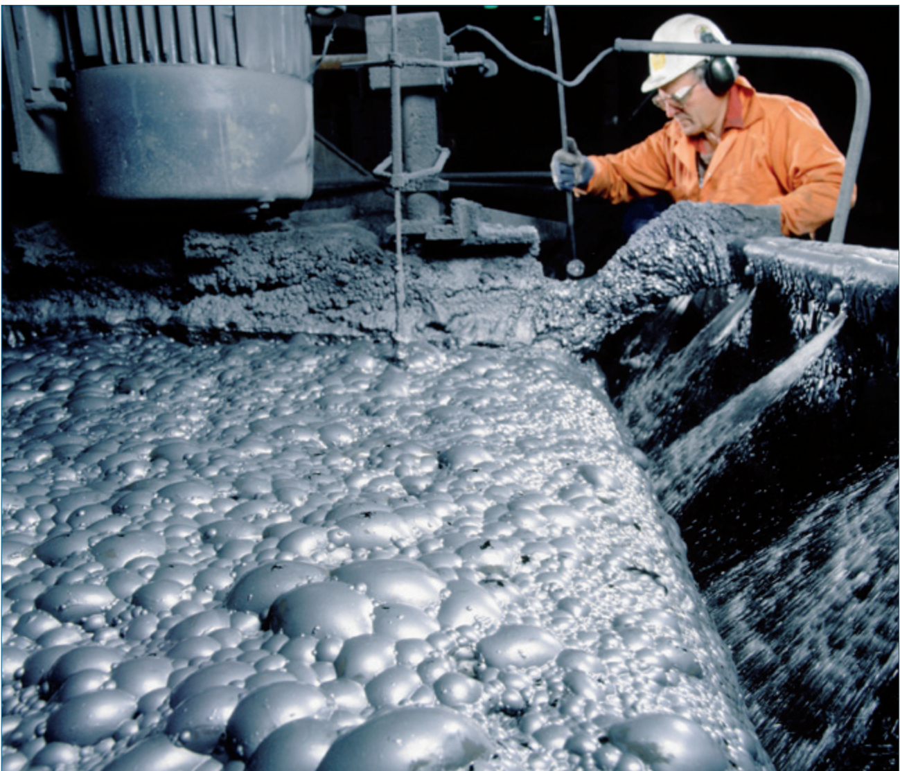
Bild 9: Flotationszelle in der Erzaufbereitung (Clariant)
