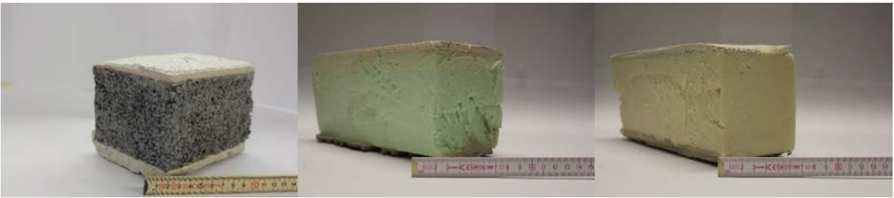
Abbildung 7: Beispielhafte Darstellung von Probekörpern (links.: EPS; Mitte: XPS; rechts: PIR) (Quelle: RWTH Aachen University)
