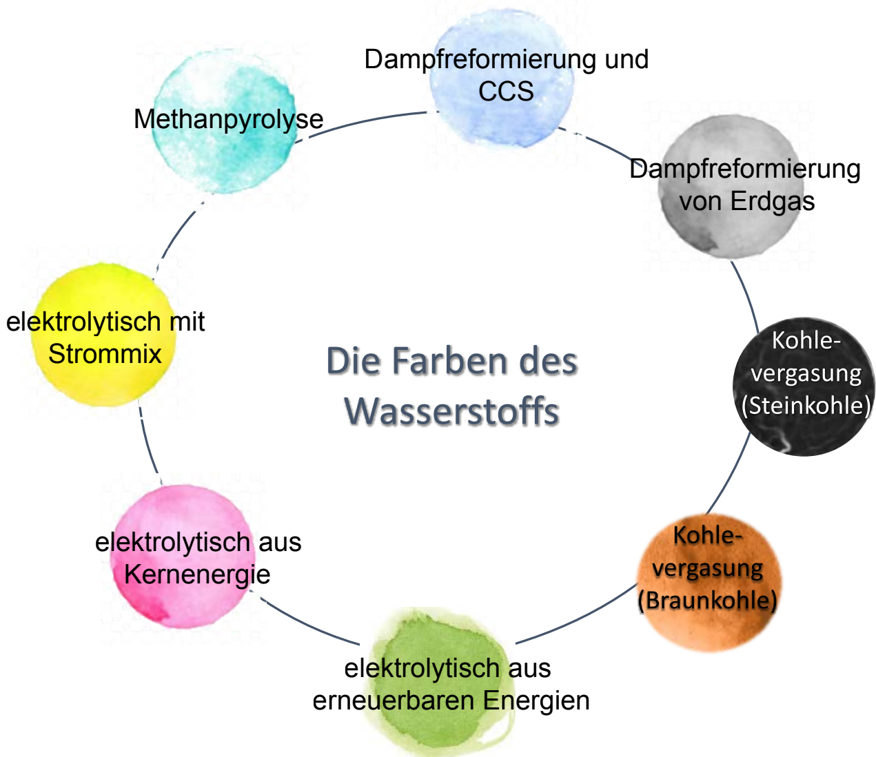
Abbildung 12.1: Darstellung der unterschiedlichen Farben des Wasserstoffs je nach Herstellungsart. Grauer, grüner, blauer und türkiser Wasserstoff sind entsprechend der Farbenlehre der NWS festgelegt, vgl. [50]. Die übrigen Farben werden teilweise unterschiedlich verwendet, wobei die folgenden Definitionen überwiegen: gelber Wasserstoff entspricht der elektrolytischen Herstellung mittels eines Strommixes (fossil, erneuerbar, Kernenergie), pinker Wasserstoff bezieht sich explizit auf Kernenergie als Stromquelle zur elektrolytischen Spaltung, brauner und schwarzer Wasserstoff wird aus Kohlevergasung gewonnen, wobei sich die Farbe nach Stein- oder Braunkohle richtet. Quellen: [126]–[128].
