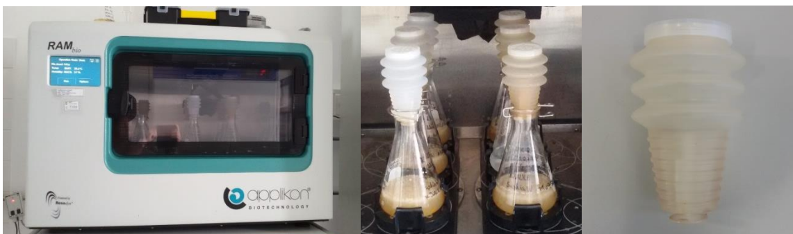
Abbildung 1: RAMbio®-System mit Submerskulturen von C. cinerea in Erlenmeyerkolben mit Oxy-Pump® Stopper
