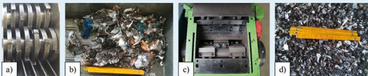
Abbildung 9 zeigt die für den ersten (a) und zweiten (c) Zerkleinerungsschritt angewandten Rotorscheren im Pilotmaßstab und deren Zerkleinerungsprodukte (b und d) bei einem Austragsrost von 20 mm (Quelle: TU Bergakademie Freiberg)
