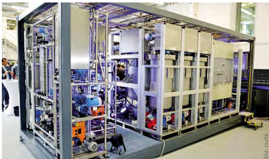
Chemie aus dem Container: Die F3-Factory von Evonik.
