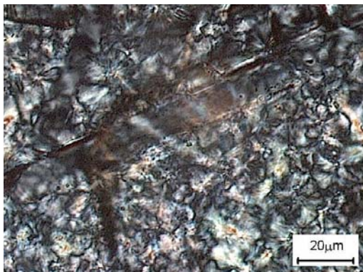
Abb. 3: Sphärolithische Morphologie des nicht nukleierten PA 6-GF30
