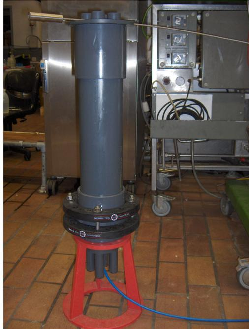
Abbildung 11: Demonstrationsanlage für kontinuierliche Magnetseparation
