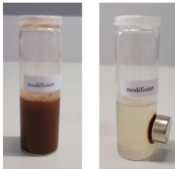
Abbildung 1: Abtrennungseffizienz bei der Magnetabscheidung
