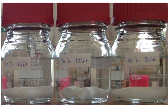
**Abbildung 4.** Verschiedene Hybrid-Monolithe (mit 10% BTMB) in Methanol.
