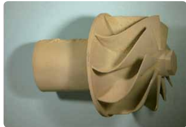
Fluorierter TiAl-Turboladerrotor für 1.200 Stunden bei 1.050°C an Laborluft oxidiert.
