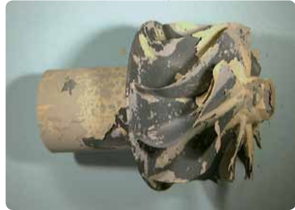
Unbehandelter TiAl-Turboladerrotor nach 1.200 Stunden Oxidation bei 1.050°C an Laborluft
