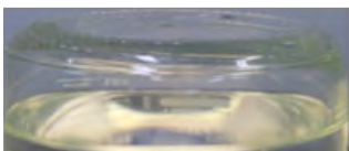
Abbildung 3 Visuelle Inspektion der Kraftstoff-Rückstellproben während des ersten Versuchslaufs mit EU5 Referenzkraftstoff
